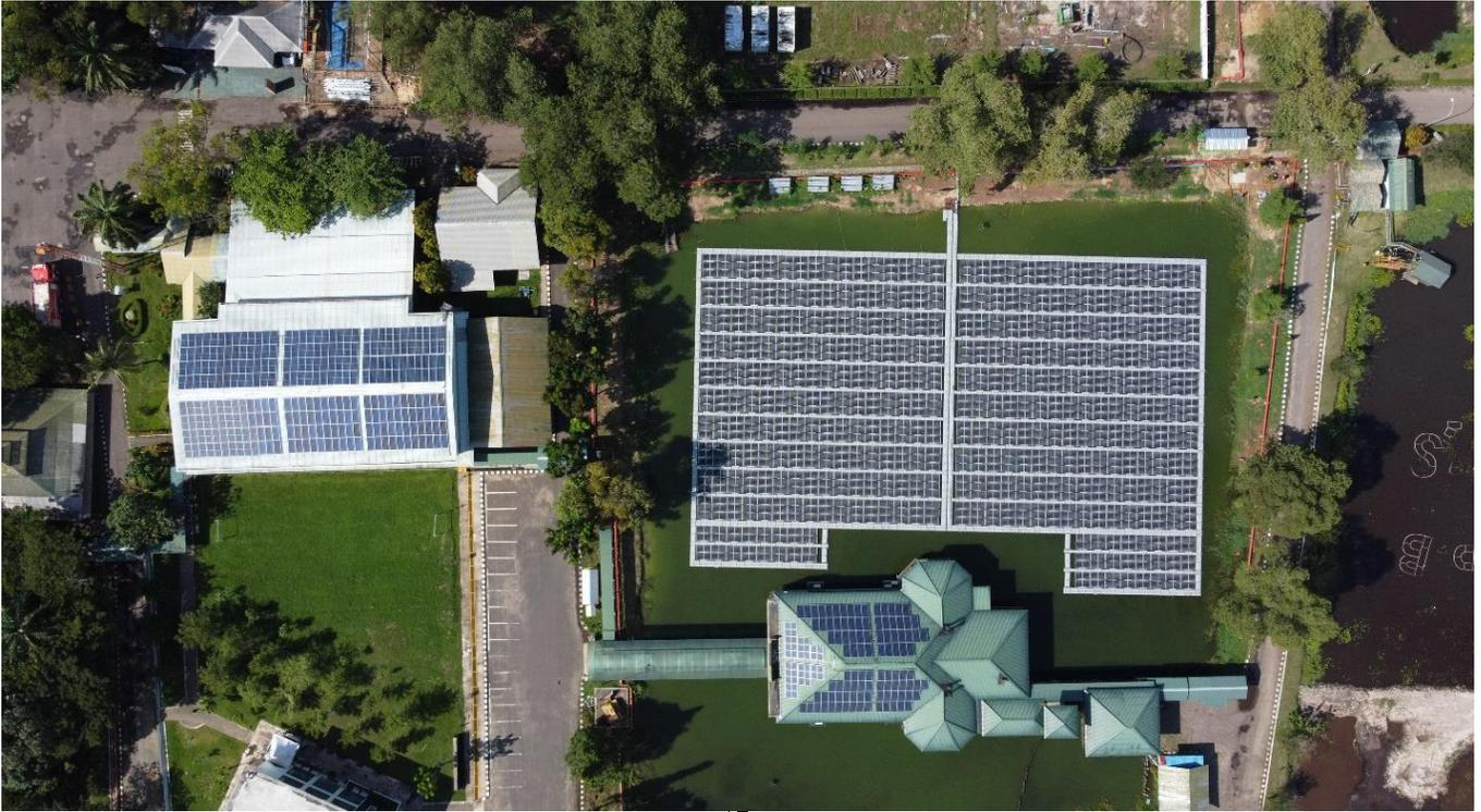
*PT Makmur Sejahtera Wisesa telah memasang panel surya fotovoltaik (PV) atap dan mengambang dengan total 597 kWp, yang dapat memproduksi sampai 749,294 kWh per tahun untuk mendukung operasi penambangan Grup Adaro.*
